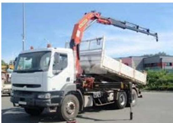
Camion-grue avec grue auxiliaire
