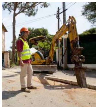
BRH monté sur mini-pelle
