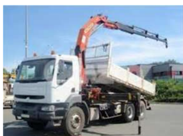
Camion-grue de 19 tonnes
