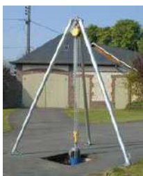
Tripode mobile de levage/ Chèvre d'atelier
