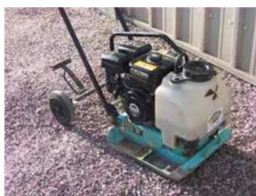
Plaque vibrante avec roues de manutention
